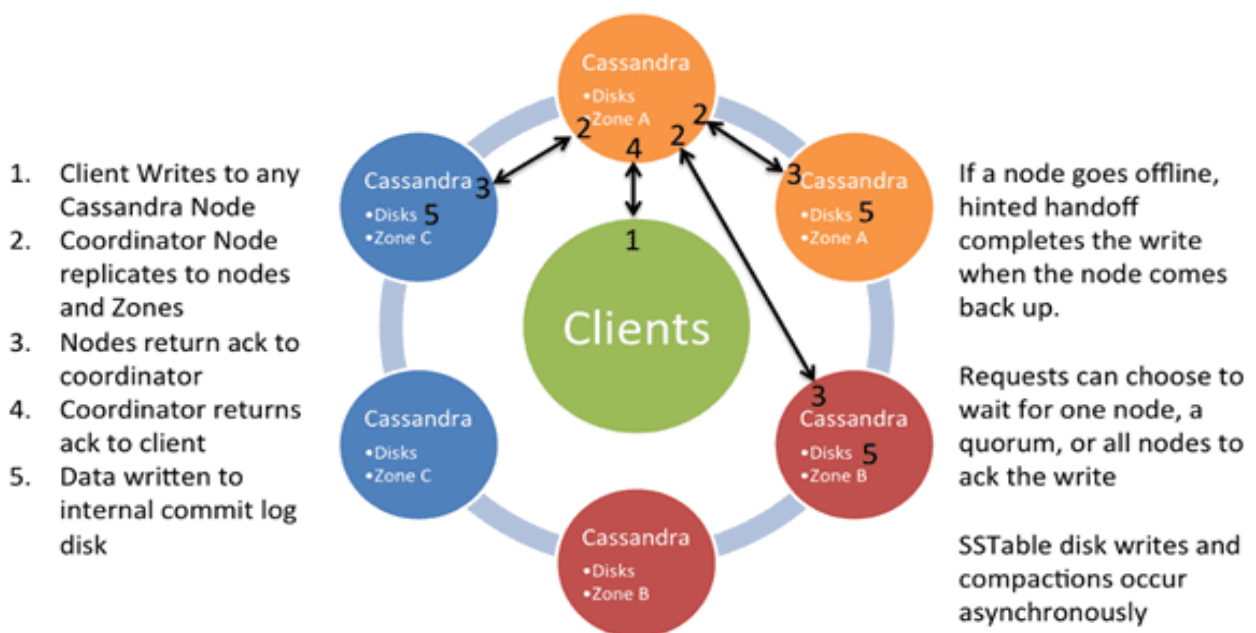
Рис. 16.5. Розподілений запис даних в кластері Apache Cassandra [2]
