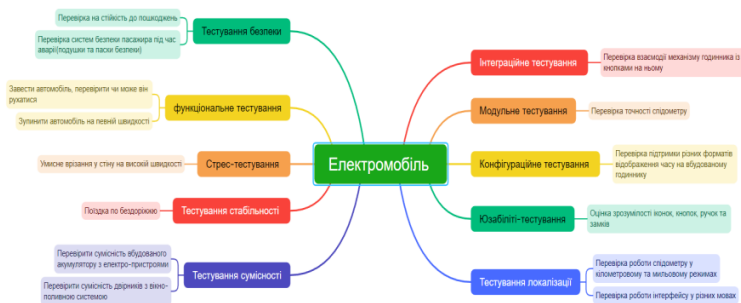
Рисунок 2.2 – Схема з класифікацією видів тестування електромобіля.
