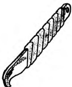
Рис. 115. Різак для різання листових пластмас
